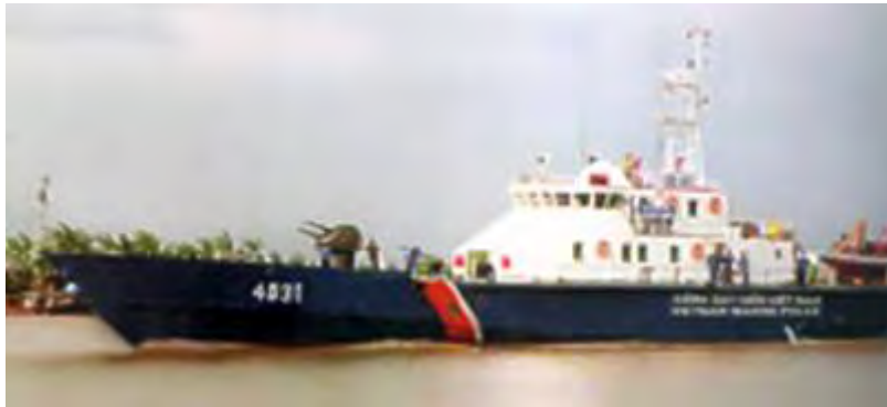
Hình 203. Một Tàu Cảnh-Sát Biển, TT120, vỏ hợp kim nhôm 120 tấn, công-suất trên 4,500 HP, Công ty đóng tàu 189 (Hải Phòng).
